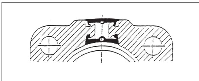
**Piston - chariot** Ils sont en alliage d'aluminium extrudé avec des patins de guidage en thermoplastique. Le piston est monté avec un joint à lèvres qui compense automatiquement l'usure; sur demande il peut être équipé avec des aimants permanents (Série S1).
