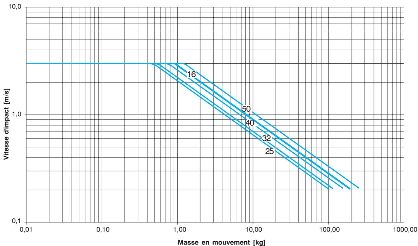
Si l'énergie cinétique de la masse en mouvement ne peut être absorbée et il n'est pas possible de changer les paramètres (a - b - c indiqués à page 11), il est indispensable d'appliquer un décélérateur supplémentaire afin de réduire la vitesse de la charge avant l'amortissement du vérin;
