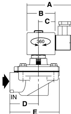
Abb. 1: Gewindeanschlüsse - Aluminium
