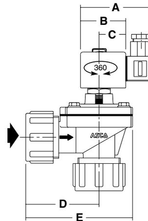
Abb. 2: Schnellverschraubung - Aluminium
