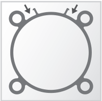
Profilé du tube avec rainures capteurs intégrées Original UNIVER depuis 2005
